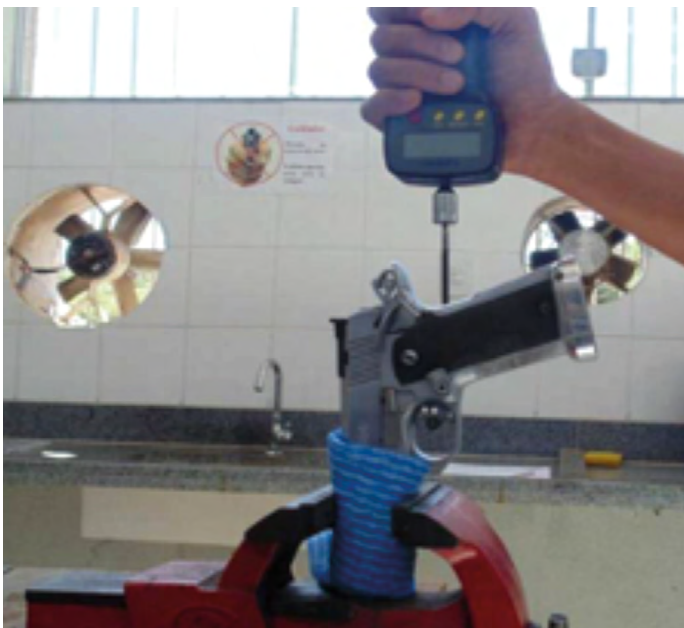
Vistas do dinamômetro e das medições realizadas no mecanismo de disparo (gatilho) da arma questionada AFQ1, considerando a arma em sua posição horizontal (paralela ao chão) e vertical (boca do cano perpendicular ao chão), conforme ilustrado acima
