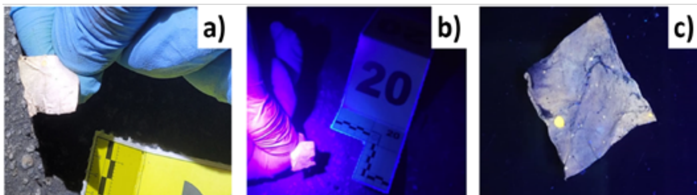
Figura 10: a) Sensor com resíduos de pós-explosão sob luz visível; b) detecção de resíduos de pós-explosão in loco; c) revelação de resíduos de pós-explosão com o sensor sob luz UV (365nm). Fonte: os autores.
