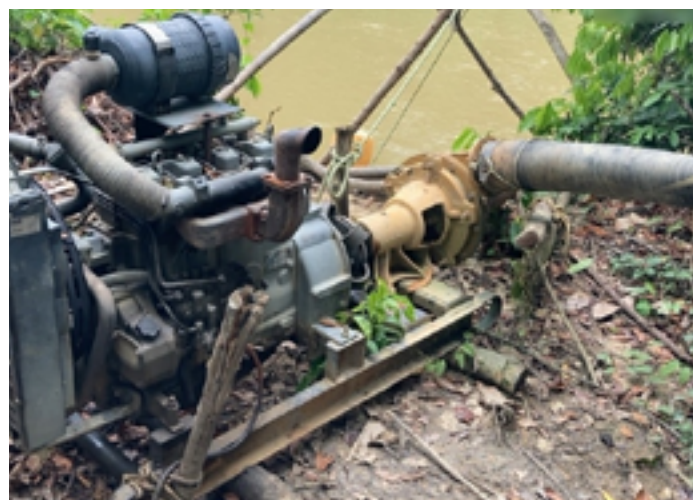
Figura 1: Motor e bomba d'água utilizados no garimpo às margens do rio Catrimani.
